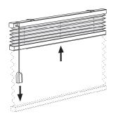
2 Отвёрткой осторожно нажмите выступ прижимной пластины и снимите жалюзи с кронштейна.
